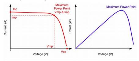
Pour bénéficier d'une puissance maximale, il faut que la résistance du circuit associé soit optimisée pour que le point de fonctionnement du circuit passe par le point de puissance maximale :
